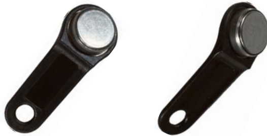
Bild 1: Benutzer Chipschlüssel iButton ca. 5 cm Länge, mit .Edelstahl Kontaktchip als Schlüsselanhänger
